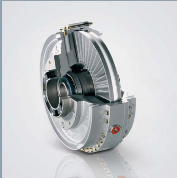
Dans un entraînement, les coupleurs hydrauliques FLUDEX® limitent les couples de démarrage et les couples maximum. Grâce à leur glissement en fonctionnement, ils soulagent le moteur durant la phase de démarrage, protègent l'installation contre les surcharges en cas d'anomalie et filtrent les vibrations torsionnelles.
