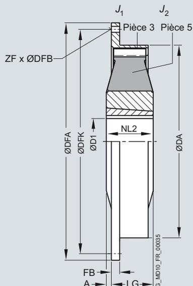
L'élément à plateaux en caoutchouc ne peut être démonté qu'une fois les machines déplacées.
