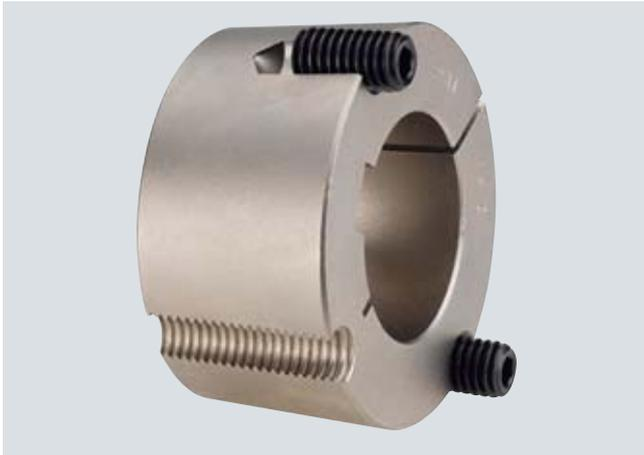
Les douilles de serrage Taper sont des éléments de machine reliant l'arbre d'une machine à un moyeu par liaison de forme et de force. L'arbre de la machine est à réaliser en forme cylindrique et avec rainure. L'élément moyeu doit avoir un alésage de logement conique avec taraudages spécifiques et alésages de serrage.
