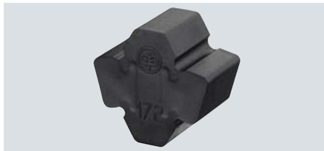
Les paquets de la série N-EUPEX DS sont soumis à des sollicitations de pression et de flexion. En cas de destruction des paquets, les pièces métalliques tournent sans contact les unes contre les autres ; l'effort est transmis séparément. L'installation de nouveaux paquets permet la réutilisation de l'accouplement. La propriété de non-résistance aux surcharges de la série N-EUPEX DS est par exemple exigée pour des machines particulièrement sensibles.
