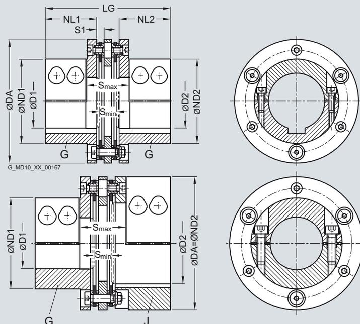
La tolérance d'arbre doit impérativement être indiquée à la commande. L'indication s'effectue avec -Z au niveau de la référence et les indications en abrégé Y26 et Y27 avec une indication en texte clair de la tolérance d'arbre pour D1 et D2.
