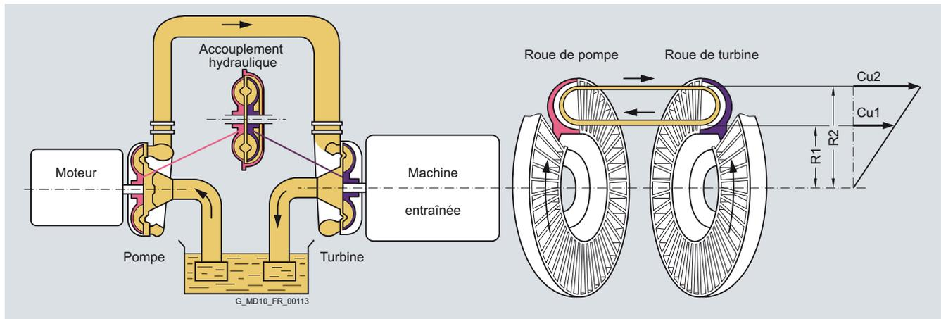
Deux roues à ailettes radiales sont placées face à face dans un carter étanche aux liquides. Les deux roues ne sont pas reliées mécaniquement entre elles. La transmission du couple est indépendante du sens de rotation en raison des ailettes disposées parallèlement à l'axe et est assurée exclusivement par le liquide.
