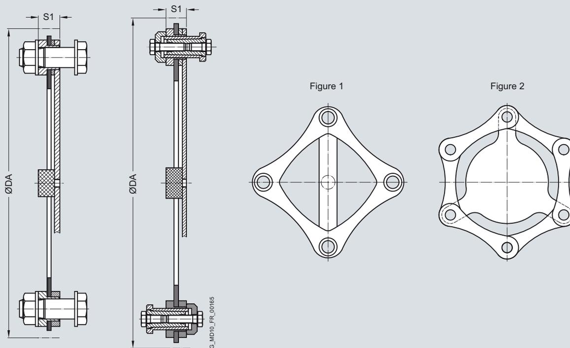
Les tampons à lamelles de la série ARW-4 sont dotés de lamelles circulaires (fig. 1), tandis que ceux de la série ARW-6 sont dotés de lamelles à barres (fig. 2).
