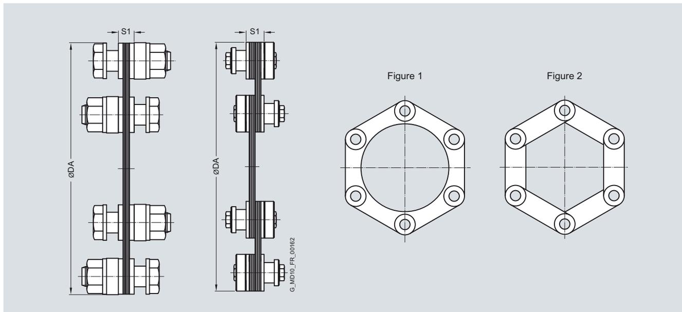
En ce qui concerne les tampons à lamelles, les lamelles les plus souvent utilisées sont les lamelles circulaires (fig. 1). Les tailles 298-6 et 325-6 sont dotées de lamelles à barres (fig. 2).
