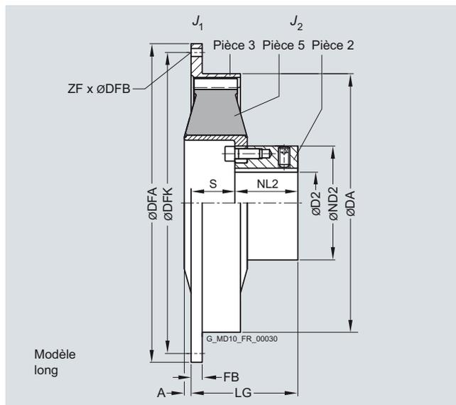
L'élément à plateaux en caoutchouc ne peut être démonté qu'une fois les machines déplacées.
