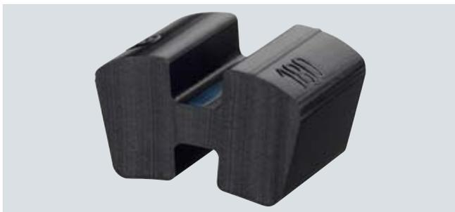
Les paquets de l'accouplement N-EUPEX sont soumis à une sollicitation de pression. En cas de destruction des paquets, un contact métallique des parties de moyeu a lieu. Cette "propriété de fonctionnement en mode dégradé" est souvent exigée pour des pompes à incendie, par exemple.
