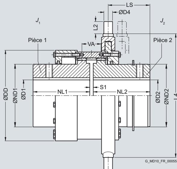
Embrayage/débrayage possible à l'arrêt. Les surfaces de glissement doivent être protégées de l'encrassement et de la corrosion ; application de graisse d'adhérence.
