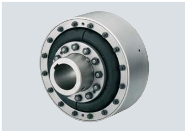
Les accouplements ELPEX se caractérisent par une haute élasticité torsionnelle et l'absence de jeu angulaire. En raison de sa faible rigidité torsionnelle et de sa capacité d'amortissement, l'accouplement ELPEX est particulièrement adapté à la liaison des machines avec un couple non uniforme. En outre, les accouplements ELPEX conviennent à la liaison de machines avec un décalage d'arbre élevé.
