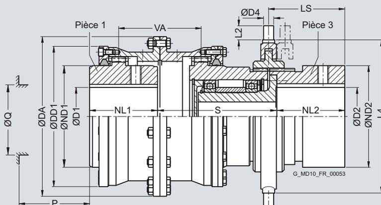
Embrayage/débrayage possible à l'arrêt.
