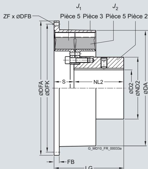
L'élément à plateaux en caoutchouc ne peut être démonté qu'une fois les machines déplacées.
