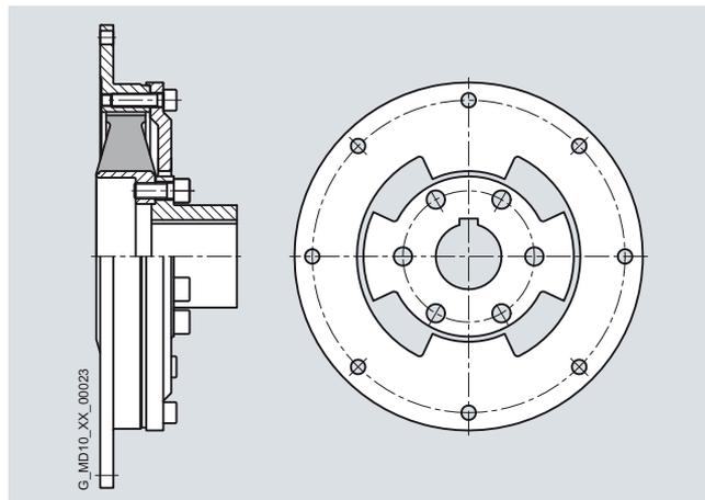
L'accouplement ELPEX-S peut également être doté d'un dispositif de sécurité positive. En cas de problème avec l'élément à plateaux en caoutchouc, l'accouplement peut continuer d'être utilisé pendant un court moment en mode de secours. Cette option est souvent réclamée pour les entraînements pour bateaux.
