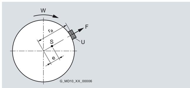
La force de déséquilibre augmente linéairement avec l'écart entre le centre de gravité du corps et l'axe de rotation, le poids du corps et la vitesse du rotor au carré.
