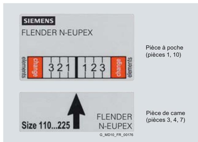
L'indicateur d'usure doit être collé après le montage de l'accouplement sur le diamètre extérieur de l'accouplement.
