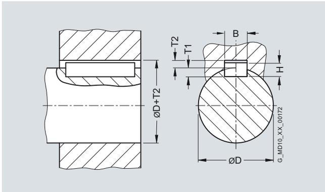
Pour des conditions de service modérées une tolérance rainure-moyeu JS9 est recommandée.
