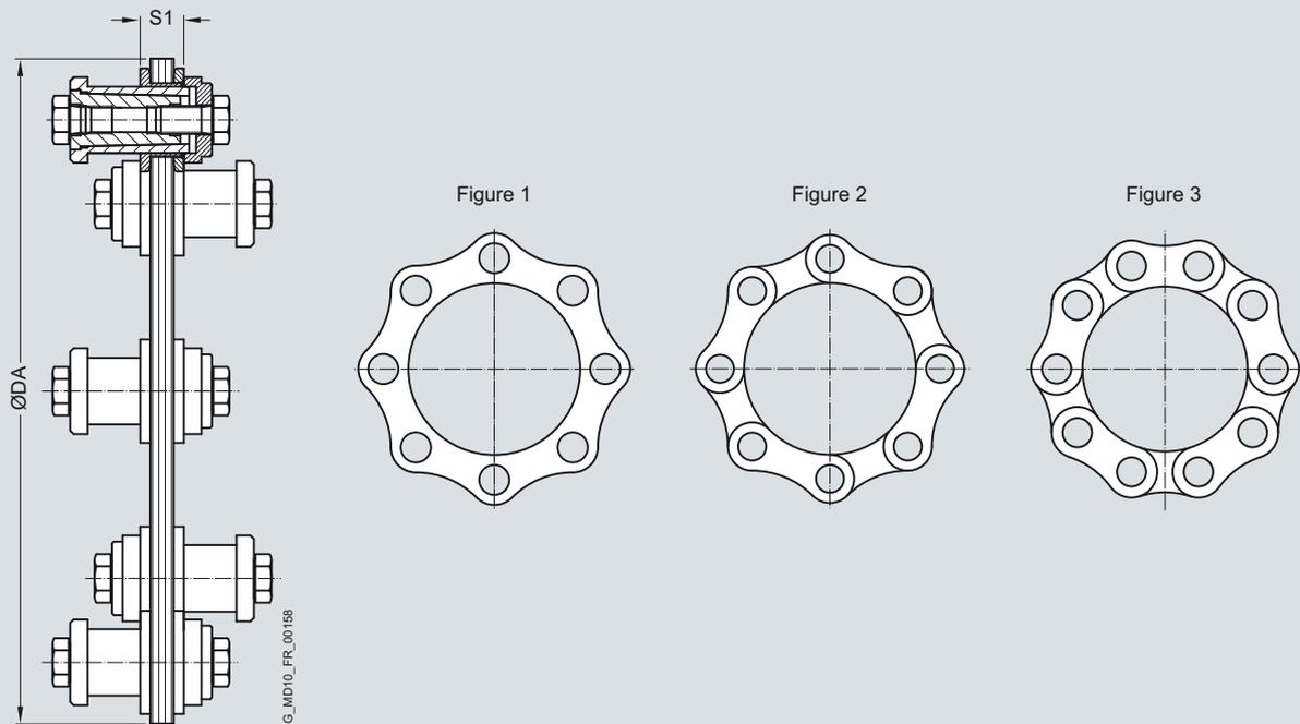
Les tampons à lamelles de la série ARC-8 sont dotés jusqu'à la taille 595-8 de lamelles circulaires (fig. 1) et à partir de la taille 630-8 de lamelles à barres (fig. 2). Les tampons à lamelles de la
