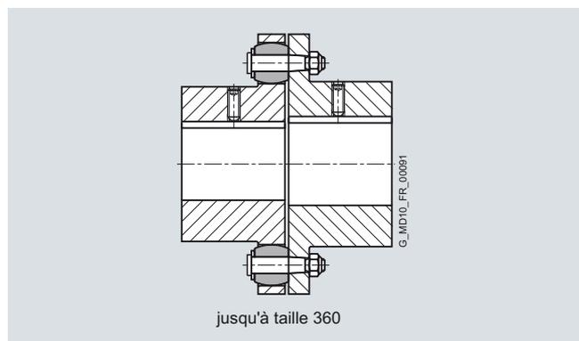
Types RWN/RWS – Disposition d'un seul côté des broches et des tampons
