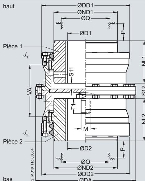
Lors de la commande, la taille de taraudage M et la profondeur de taraudage T1 doivent être indiquées.
