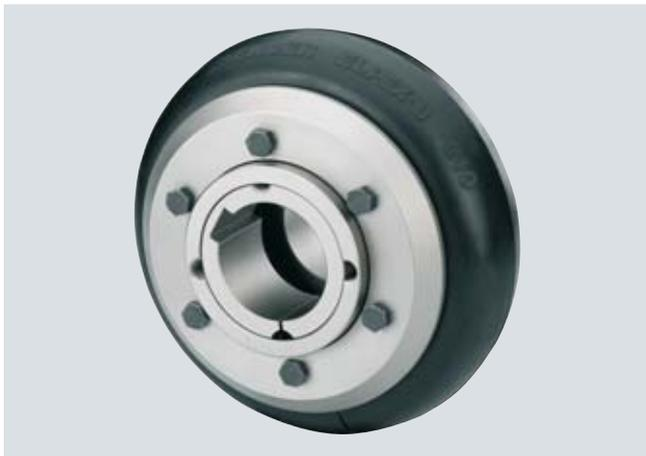
Les accouplements ELPEX-B se caractérisent par une haute élasticité torsionnelle et l'absence de jeu angulaire. En raison de sa capacité d'amortissement et de sa faible rigidité torsionnelle, l'accouplement ELPEX-B convient très bien pour la liaison des machines avec un couple non uniforme. Les accouplements ELPEX-B conviennent à la liaison de machines dont les arbres présentent un décalage important.
