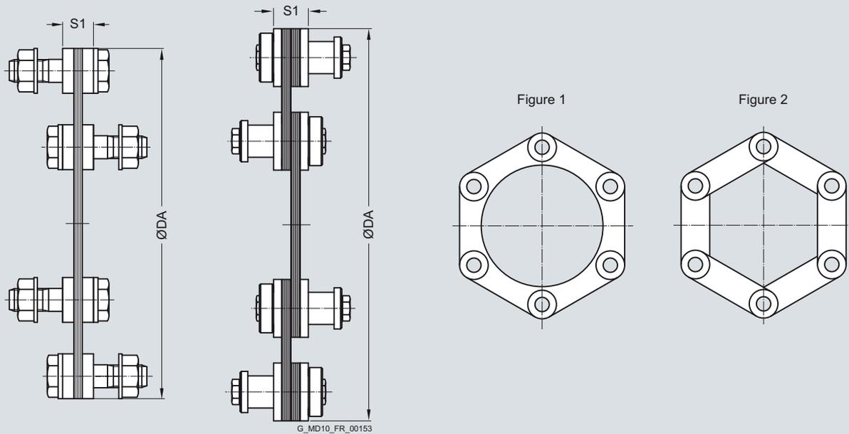
Les tampons à lamelles sont dotés jusqu'à la taille 255-6 de lamelles circulaires (fig. 1) et à partir de la taille 280-6 de lamelles à barres (fig. 2).
